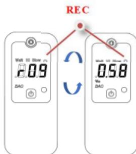
Im Aufnahmemodus blinken die Testnummer und ihr Messwert abwechselnd auf der LED. Zum Beispiel ist der 9. Datensatz **0.58‰ BAC** (= **.058% BAC**) , dann blinken **r09** und **0.58‰** abwechselnd.
