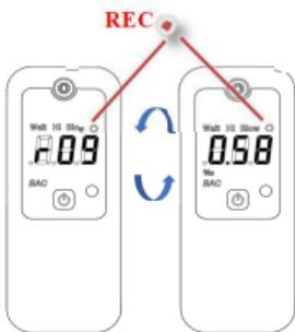
Nella modalità di registrazione, il numero del test e la sua lettura lampeggeranno alternativamente sul LED. Ad esempio, il nono record è 0,58% BAC (= .058% BAC), r 09 e 0,58% (.058%) lampeggeranno alternativamente.
